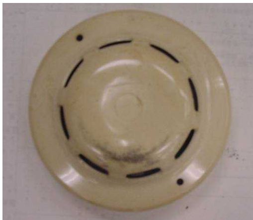
煙感知器防虫網付近の汚れ
