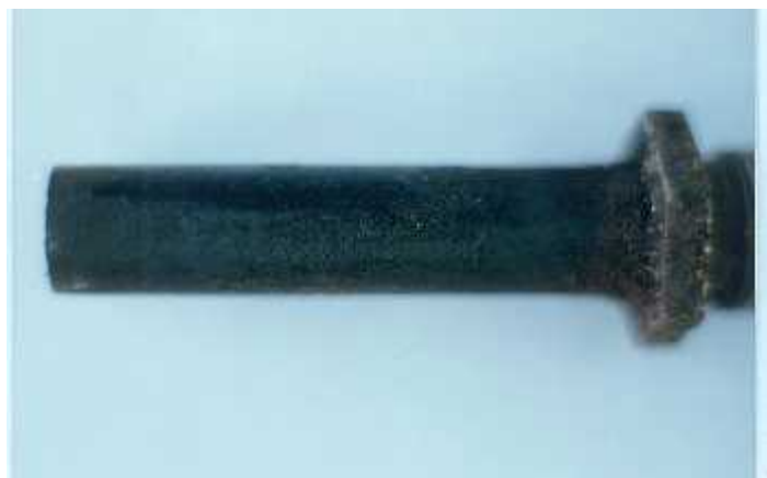
定温式スポット型感知器（防爆型）油付着
