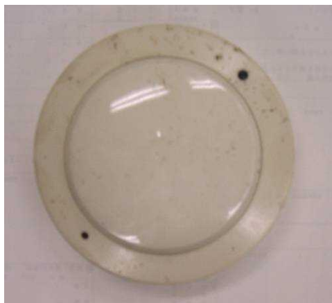
差動式スポット型感知器の錆
