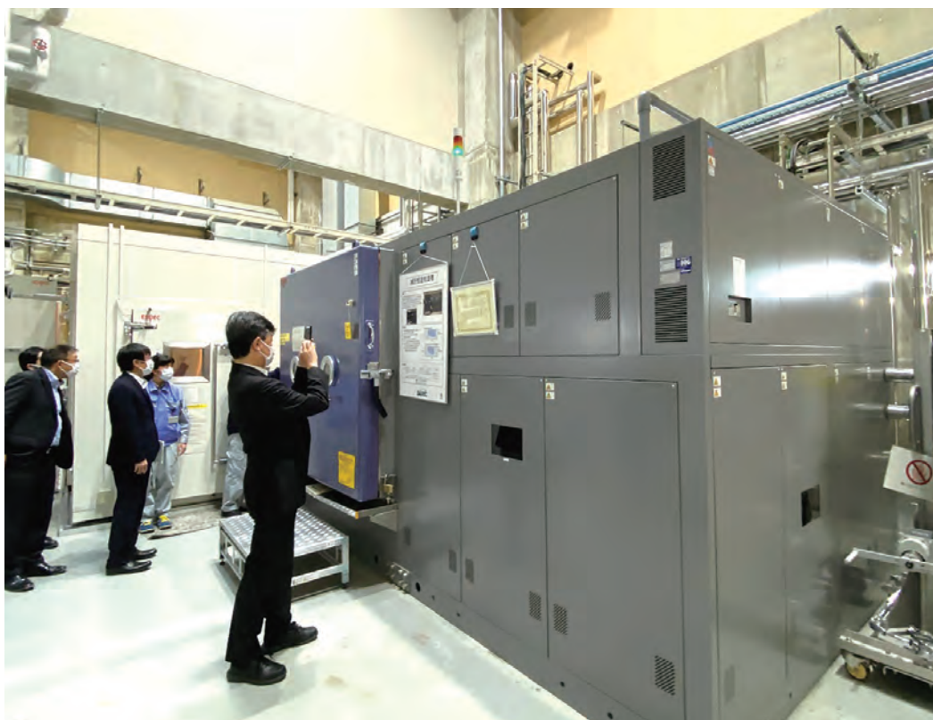
外部試験サイトでの実験風景（恒圧恒温恒湿槽）
