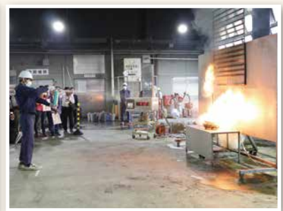
住宅用消火器による天ぷら油火災の消火実験
